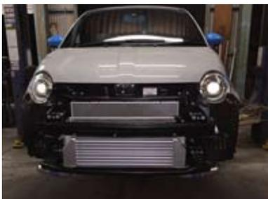
各部の取り付けが全て完了しましたら、バンパーを装着する前にエンジンを始動してパイピングが干渉しないか、空気が漏れていないかを確認して下さい。バンパーにはインタークーラー本体が干渉しない設計となっておりますが、仮組をして当たらない事を確認してから本組をして下さい。万が一個体差により干渉する場合には、干渉箇所をカットして組み立てをお願いします。バンパーとアンダーパネルを取り付けましたら、作業は完了です。
