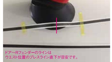
ドアミラーフットにかかる部分は、浮かせた状態で仮止めてください。位置決めが決まりましたら、浮き部分のセンターにハサミを入れ分割してから定着作業に入ってください。
